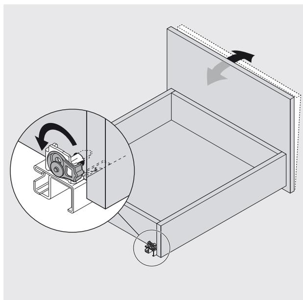
Mit der integrierten Fronten-Neigungsverstellung können Sie die Front parallel zur Korpusvorderkante ausrichten - und das schnell, bequem und werkzeuglos.
