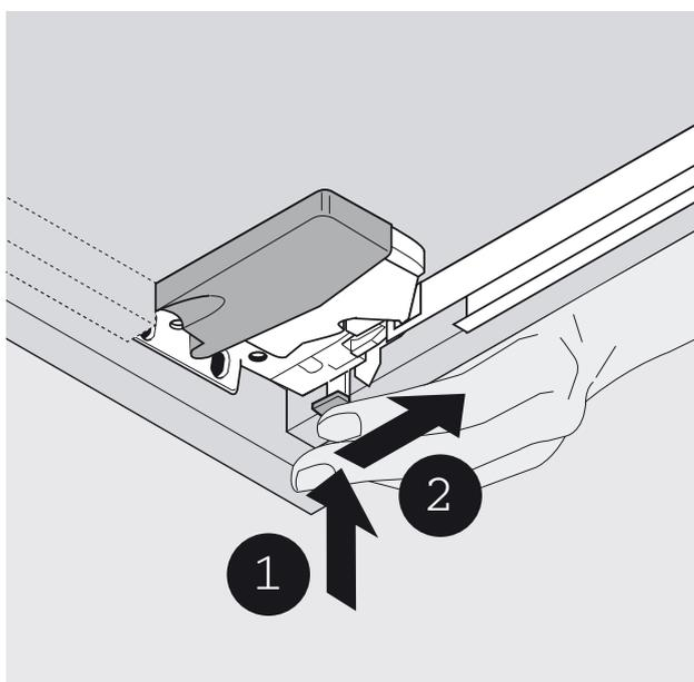
Für ein harmonisches Fugenbild nehmen Sie die werkzeuglose Höhenverstellung vor. Sie ermöglicht einen Höhenausgleich von bis zu 3mm
